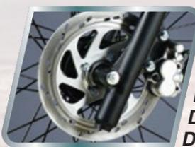
Freno a Disco Delantera de Doble Cilindro
